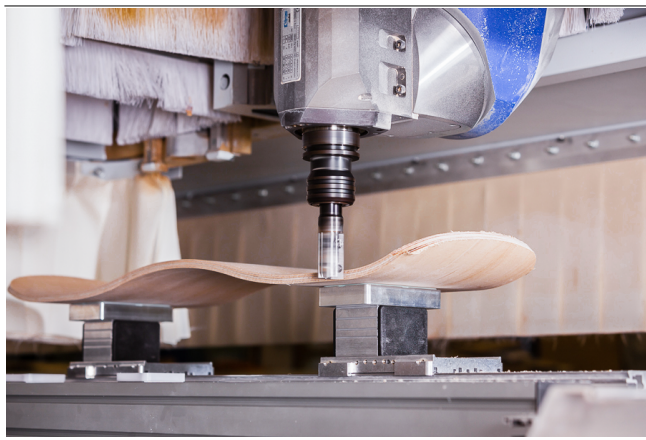
Blocchi di aspirazione VCBL-A-K2 in alluminio per il bloccaggio del legno massello
